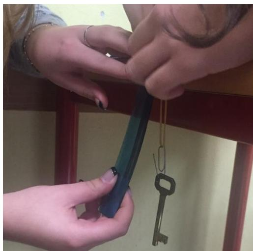
Misurazione allungamento dell'elastico con il peso di una chiave
