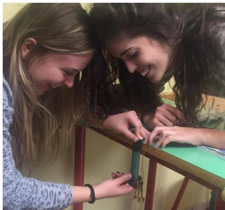
Misurazione allungamento dell'elastico con il peso di quattro chiavi
